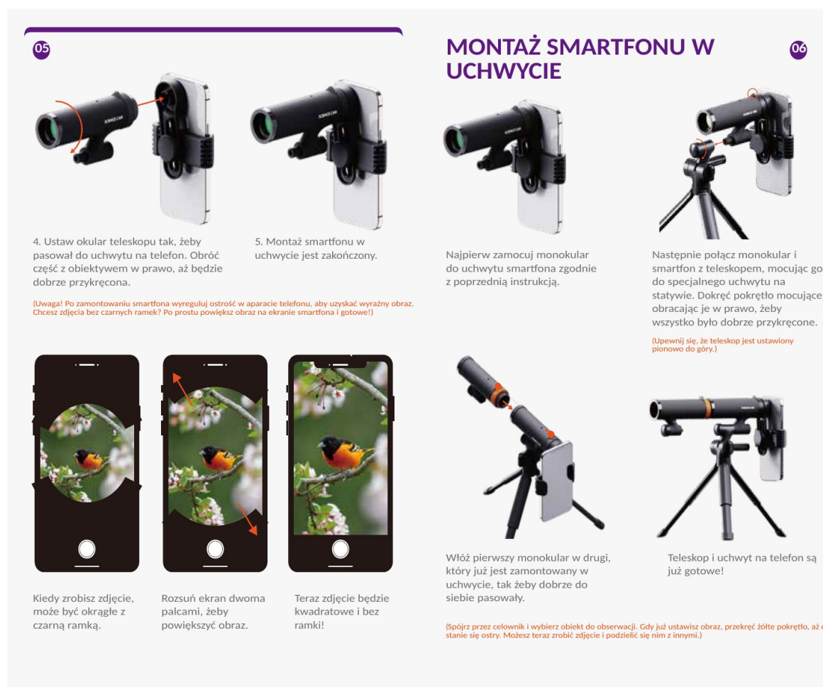
Ilustracja 3. Montaż smartfona i teleskopu pionowego.
